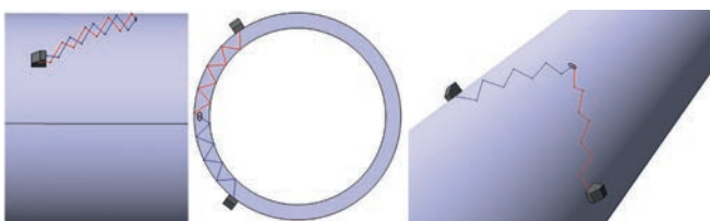
Bild 1: Schematische Darstellung der Strahlenverfolgung in einer umlaufenden Schweißnaht
